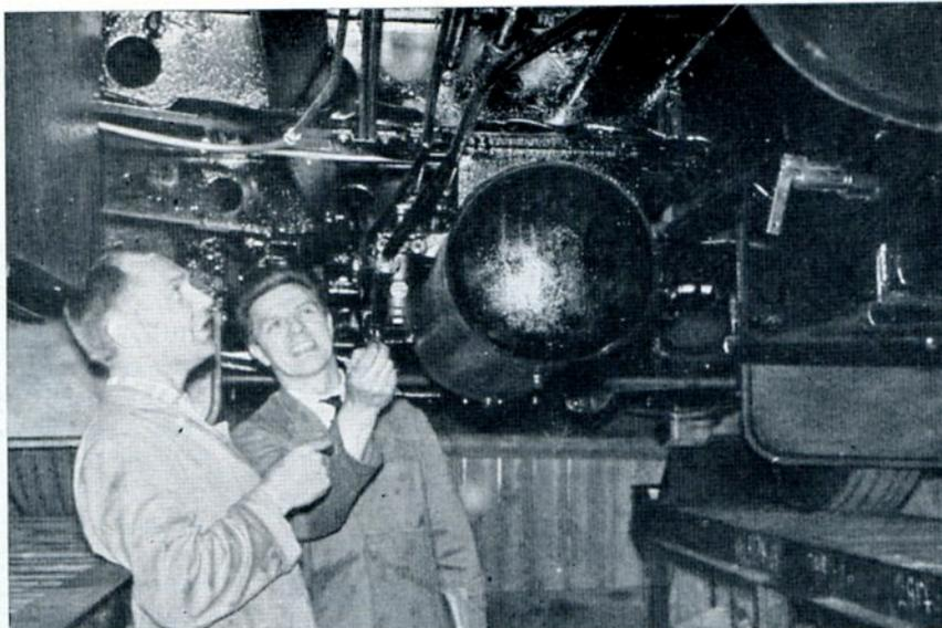
Nos collègues E. Goosens et R. Marchand inspectent le réservoir à air sous l'essieu-avant.
